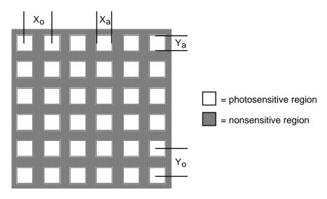
**Figure 18**: Pixel form parameters
